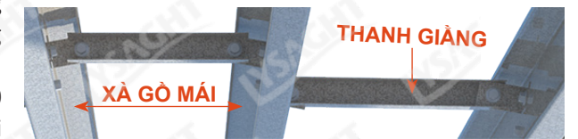
Hình 7.4.2.b Lắp mỗi thanh giẻng C51 vào 2 pat giẻng
