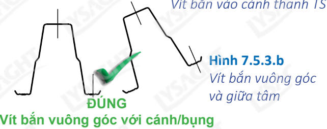
Hình 7.5.3.a Vít bắn vào cánh thanh TS
