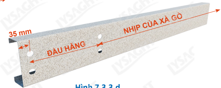
Hình 7.3.3.d Xà gồ có đầu hẫng: Lỗ cách mép 35mm và lỗ ngay cóc xà gồ
