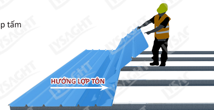
Hình 5.3.3.3.b Lợp tấm đầu tiên cẩn thận để làm chuẩn cho các tấm sau
