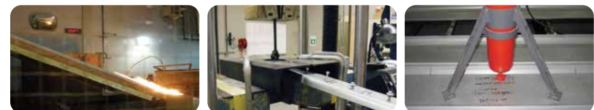
Thí nghiệm cháy lan theo tiêu chuẩn ASTM E108 ASTM E108 spread of flame tests
