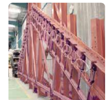
Kiểm tra sức chịu tải tổng thể giàn Testing overall truss load capacity
