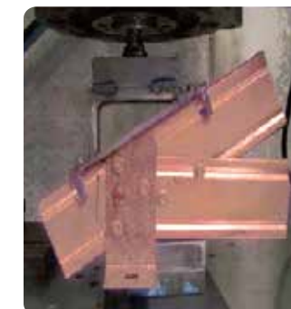
Kiểm tra sức chịu tải liên kết vít Testing load capacity of bolt joint
